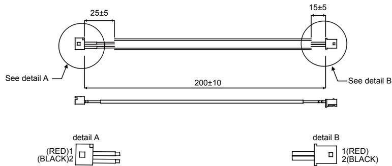
● 電池盒連接線 IW ( 連接驅動器 CN8 接口 ) 單位 : mm
