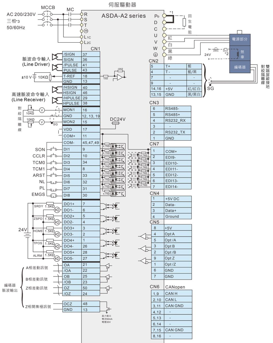
\*1: 4.5kW以下機種有內建煞車電阻
