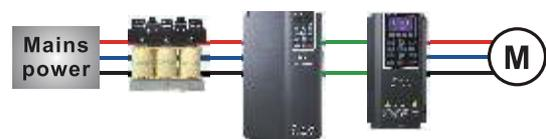
搭配AFE不僅能節約能耗，同時有效抑制轉矩脈動，提高功因，降低諧波，為進階起重主吊系統之最佳配置。
